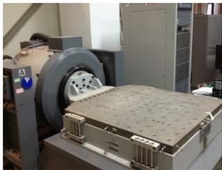
5t振动台（带水平滑台）
