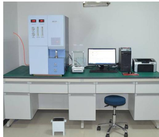
**元素分析设备：**ICP-OES、C/S分析仪、SEM&EDS
