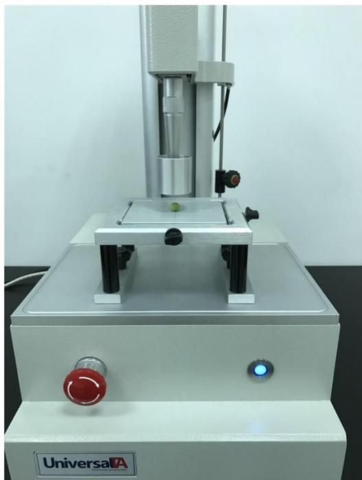
将固化后的蓝莓果粒放于柱形探头的正下方，采用 TPA 模式进行测定，测定条件：
