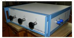
气路装置如上图所示,型号分为2路,3路,4路等规格。每路均含有一台质量流量控制器为核心控制单元。
