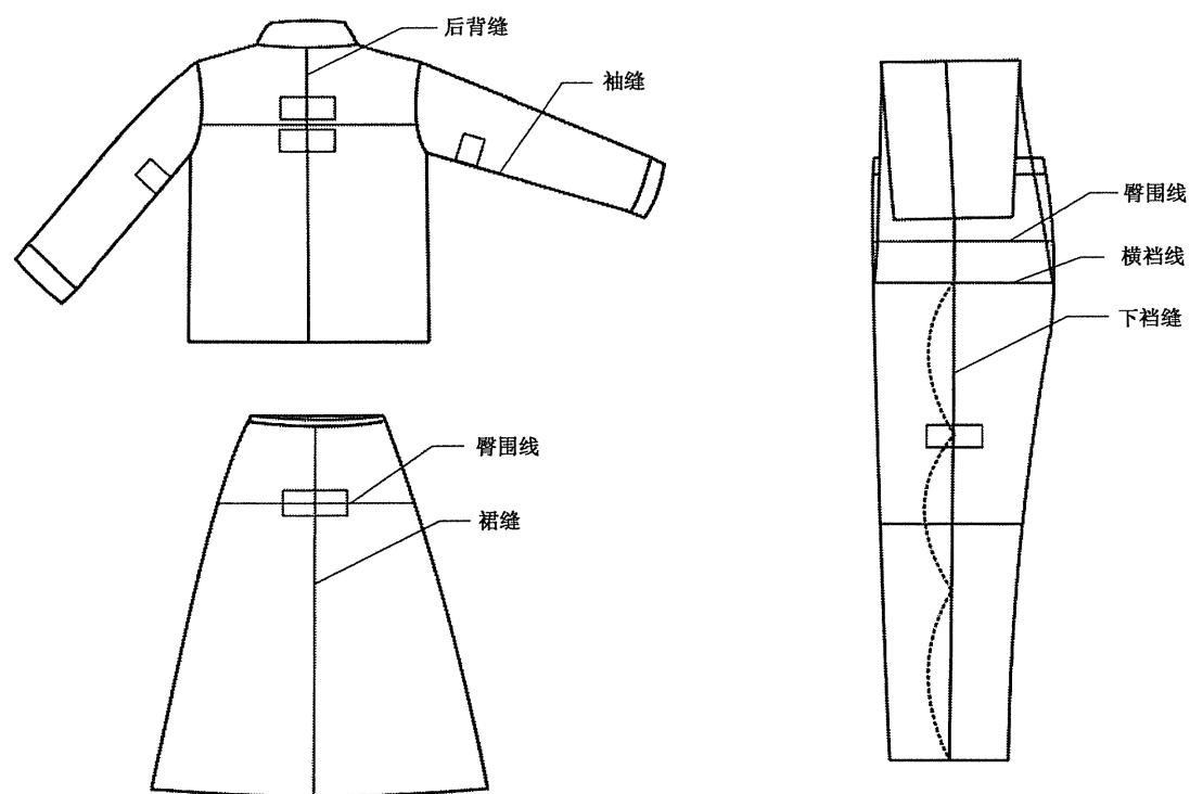
图 A.2 接缝处纱线滑移取样示意图
