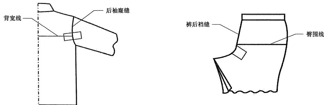
图 A.1 接缝强力取样示意图
