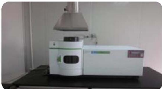
ICP-OES 电感耦合等离子体发射光谱元素分析仪
