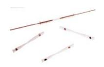
为了优化色谱柱连接,请选择适合两根色谱柱内径的石英接头。CP-Quick-Seal接头可与不同内径的色谱柱以及客户订制的色谱柱结合使用。货号为CP4779的接头可用于柱内径小于0.32mm的各种规格的色谱柱,货号为CP4787的色谱柱可用于0.53mm内径以下的色谱柱连接,这两种均是通用接头。
