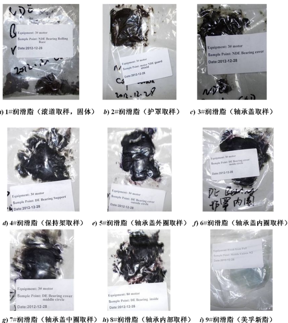
图 1 某钻井平台轴承故障润滑脂外观
