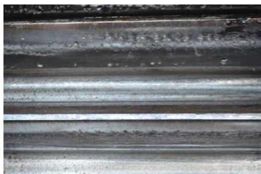
图 2 故障齿轮齿面塑性变形
