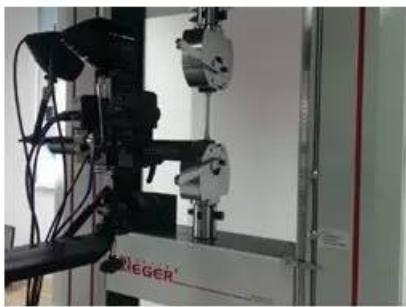
钢试件伸试验现场
